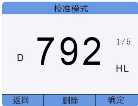
在标定过的里氏硬度块上垂直向下测量 5 点。测量 5 点完成后，显示屏会显示平均值和“AVE”标志。
