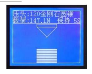
● 测量标尺齐全:可以进行洛氏 HRA、HRB、HRC、HRD、HRE、HRF、HRG、HRH、HRK、HRL、HRM、HRP、HRR、HRS、HRV,和表面洛氏 HR15N、HR30N、HR45N、HR15T、HR30T、HR45T、HR15W、HR30W、HR45W、HR15X、HR30X、HR45X、HR15Y、HR30Y、HR45Y 共 30 种标尺的测量,被测材料覆盖各种硬度范围,如硬质合金、淬火钢、合金钢、软钢、铜、铝合金、工程塑料、人造木板等。
