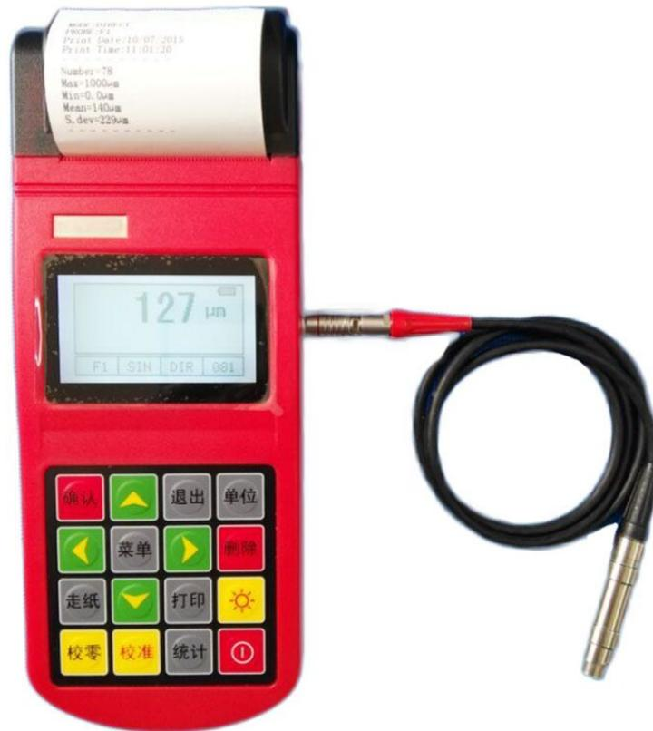
本仪器是一种便携式测量仪，它能快速、无损伤、精密地进行涂、镀层厚度的测量。既可用于实验室，也可用于工程现场。通过使用不同的测头，还可满足多种测量的需要。本仪器能广泛地应用在制造业、金属加工业、化工业、商检等检测领域。是材料保护专业必备的仪器。
