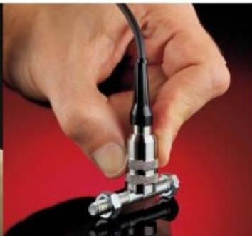
测量电镀层,氧化膜厚度.
