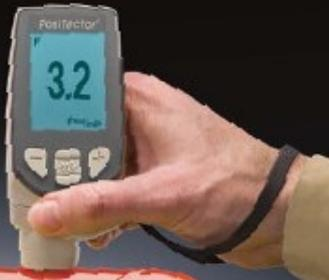
测量各种金属上油漆,粉末涂层厚度.
