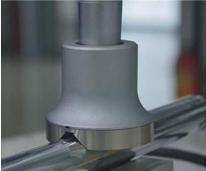
使用圆柱支撑环测量圆柱的硬度值
