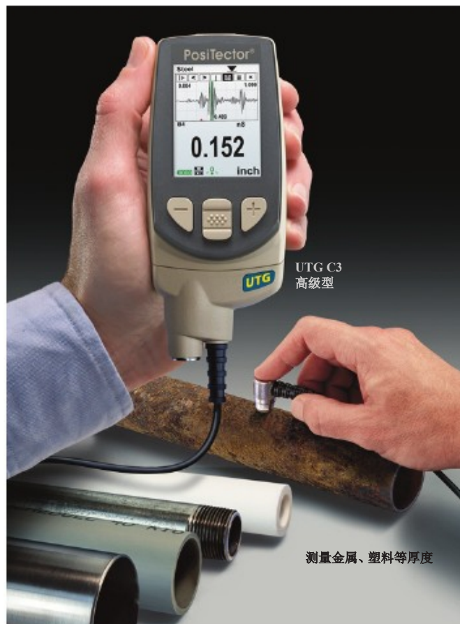
测量 金属、塑料等厚度 UTG M 多回波探头,可以穿透油漆测量已喷涂产品厚度 无需清除涂层
