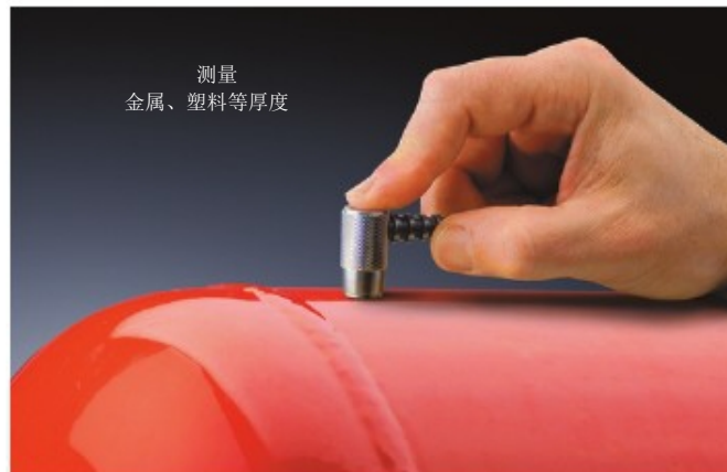
测量 金属、塑料等厚度 UTG M 多回波探头,可以穿透油漆测量已喷涂产品厚度 无需清除涂层
