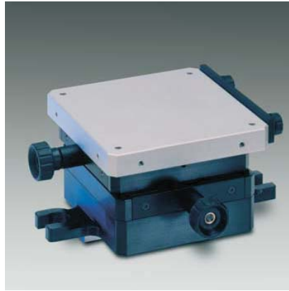
XY 平台 CT 120 订货号 6710529 用于支撑和矫正工件。 可调节两个坐标15mm (.591in) 台面尺寸120mmX120mm (4.728inX4.728in)带两个托架
