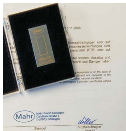
PRN 10 粗糙度标准样板 订货号 6820420 带Mahr校准证书,粗糙度样板带纹路,镀铬。 纹路大约深 10\mu\text{m} ( .394\mu\text{in} ) 用于粗糙度测量仪的校准
