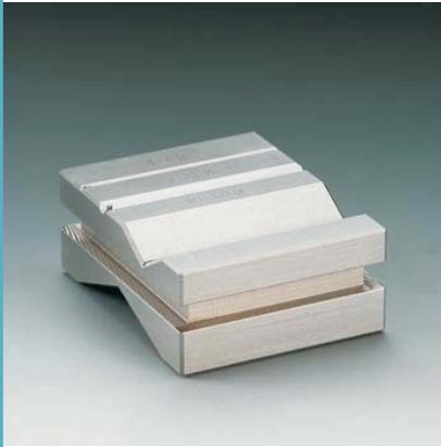
PP V型块 订货号 6710401 4条棱形槽用于支撑直径1毫米至160毫米的对称工件(0.0394in至6.30in) 外形尺寸(长X宽X高)100mmX80mmX40mm(3.91inX3.15inX1.58in) 重量1.5公斤(3.31磅)。包括用于固定在棱形槽内工作的夹紧弹簧。
