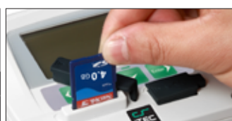
可移除的SD卡, 方便将测量数据转移到PC
