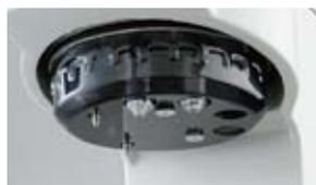
装有 2 个压头座和 4 个物镜座的电动转塔（可进行手动操作）
