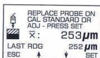
Step 2 (步骤 2) — 将探头放在没有涂镀的零板上 (平滑校准), 或放在一个薄校准板上 (两点, 粗糙, 特殊基体), 然后提起探头。重复, 读数将显示平均值 (X) 及最后一个读数。显示的读数值可以通过软键中的上下箭头键来调整到正确值上。
