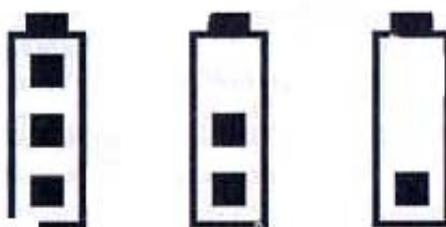
图示的电池容量变空，且仪器每 10 秒发出一声报警时，电池应被更换。
