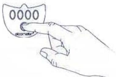
对集成探头式仪器，仪器探头放置被测表面时自动开启。
