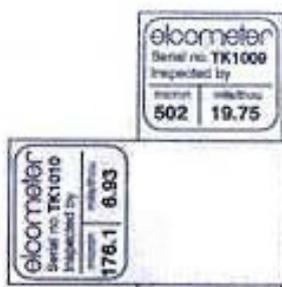
**SMOOTH** (光滑平坦表面校准) — 光滑平坦无漆表面校准仪器的零位。放置已知厚度的模板后, 可校准仪器到此厚度。
