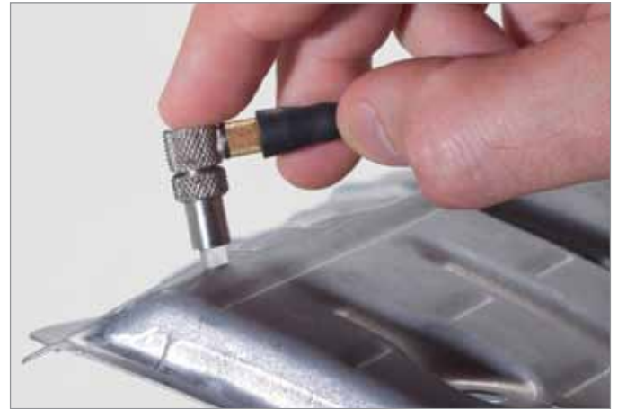
测量金属板因弯曲变形而变薄的情况。
