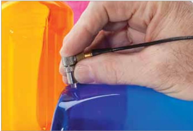
使用20 MHz延迟块探头测量薄塑料材料。
