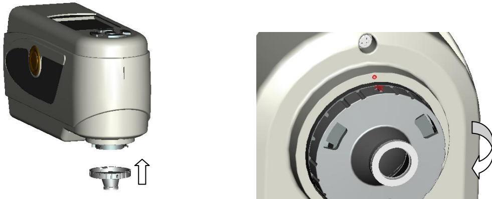
图 11 加长测量口径对准安装孔位 图 12 顺时针旋转 20 度左右，确保箭头和原点对齐
