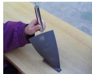
非常短小的裂纹也可以测量
